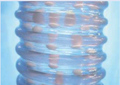
上記の写真は粒体の搬送時に起こる静電気の帯電を比較したものです。(搬送物は発泡スチロール)
