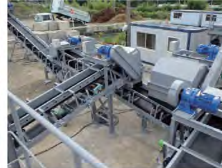
土質改良設備用コンベヤ 舟底型
