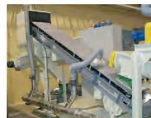
舟底型 石膏搬送コンベヤ
