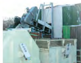
舟底型 空缶選別コンベヤ (マグネットブロー式)
