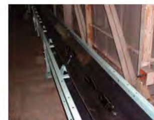
舟底型 ビール破ビン 搬送コンベヤ
