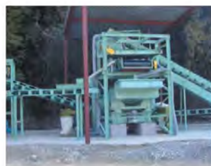
舟底型 建設廃棄物処理プラント
