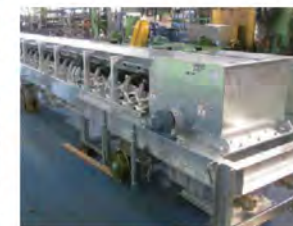
舟底型 コークス搬送コンベヤ (シャトルコンベヤ)
