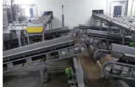
培養施設培養土搬送コンベヤ 舟底型
